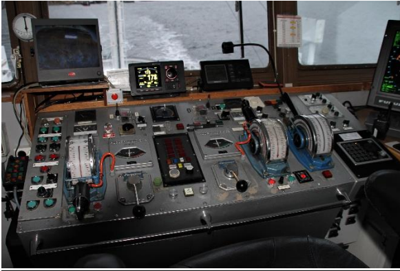
Styreconsoll med 2 propellere og ein turtallsregulator
